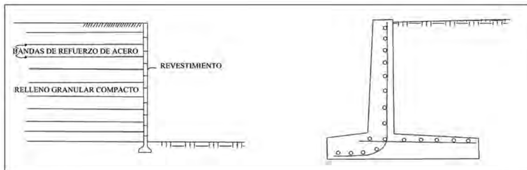
Muros de Tierra Armada
